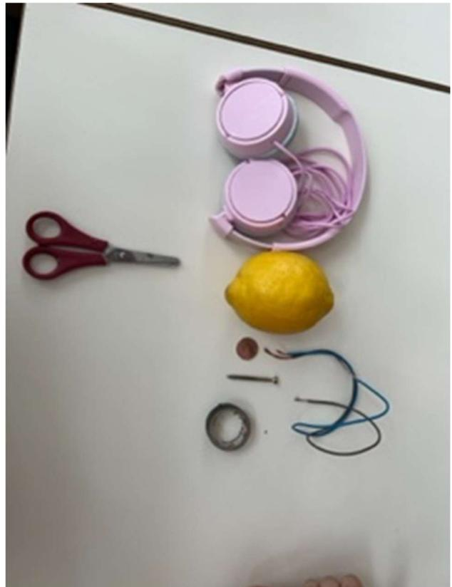
Stecke die 5-Cent Münze in den Schlitz hinein. Nun stecke die Schraube oder den Nagel in die Zitrone. Zwischen Münze und Schraube sollte etwa ein Finger passen. Achte darauf, dass sich die Gegenstände nicht berühren.
