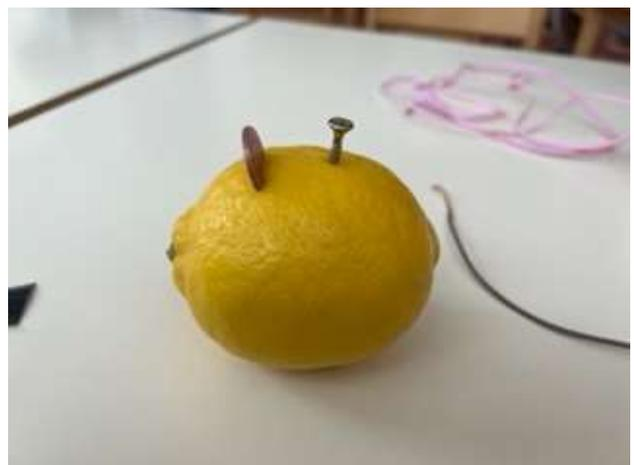
Befestige dann je ein Kabel an der Schraube und der Münze so, dass das Kabelende die Gegenstände berührt.
