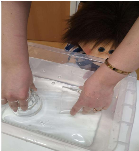
Halten Sie das zweite Glas schräg und fangen Sie die daraus aufsteigenden Luftblasen mit dem ersten Glas auf.
