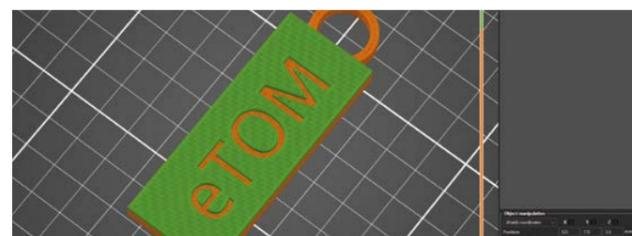
**Schritt 7:** In einem letzten Schritt wird der USB-Stick an den 3D-Drucker angeschlossen und auf dem Gerät der Druck gestartet. Je nach Größe und Material dauert der Druck eines Anhängers zwischen einer halben Stunde und einer Stunde. Im Prusa Slicer ist ersichtlich, wie lange der Druck benötigt. Sollte der Druck zu lange brauchen, empfiehlt es sich, die Größe des Anhängers anzupassen.
