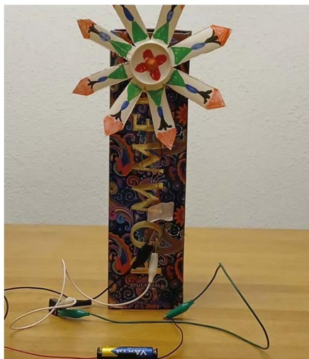
**Herstellung eines Karussells, das sich mit Sonnenlicht oder einer Batterie drehen kann. Dabei lernen die Kinder, wie ein kleiner Elektromotor funktioniert und wie man ein einfaches technisches Modell selbst herstellen kann.**
