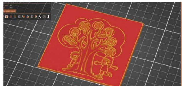
**Schritt 6:** Anschließend wird das Modell gesliced und als GCODE Datei auf einen USB-Stick gespielt, und mit dem 3D-Drucker ausgedruckt.
